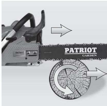
При неправильной распиловке древесины цепь может быть зажата бревном. Чтобы этого не произошло, определитесь каким образом вы будете проводить распиловку древесины. Вы можете начать процесс распиловки бревна сверху, для этого сделайте распил примерно на четверть диаметра бревна, а затем закончите распил снизу. В этом случае цепь не окажется зажатой в бревне.
