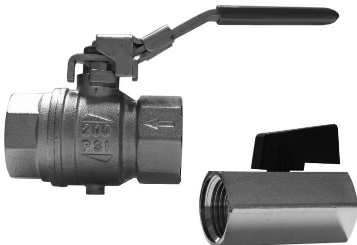
Шаровые краны предназначены для управления потоками сжатого воздуха, воды и минерального масла. Корпус крана Серии S93 имеет дренажное отверстие с резьбой M5, предназначенное для сброса воздуха из технологического оборудования при закрытии крана. Иначе, отверстие должно быть заглушено. Ручка шарового крана Серии S93 стопорится на корпусе во избежание несанкционированного, самопроизвольного поворота.
